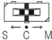
モーター回転時の電流設定はDipスイッチ・S3(103,203)の位置を下記の位置に合わせて設定します。
