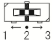
モーター停止時の電流設定はDipスイッチ・S4(104,204)の位置を下記の位置に合わせて設定します。
