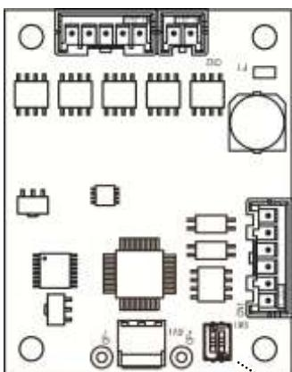
ボード上のデイップスイッチによりフル/ハーフステップを選択します。
