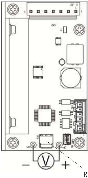
モーター回転時の電流の設定はボード上のチェックポイント
