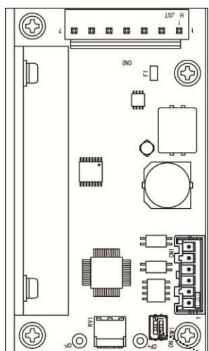
ボード上のデイップスイッチによりフル/ハーフステップを選択します。
