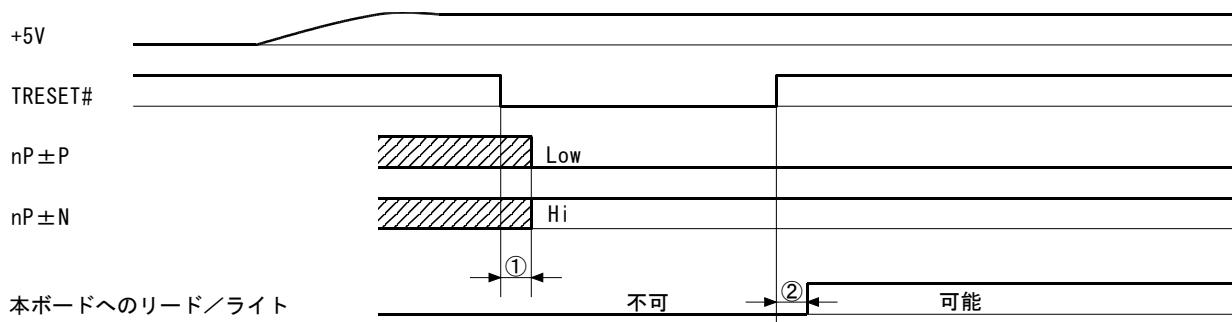
① ドライブパルス出力信号 (nP±P, nP±N) は、APIC21(アドテック社)のターゲットリセット信号 (TRESET#) の↓から最大 250 n SEC以内に確定します。
