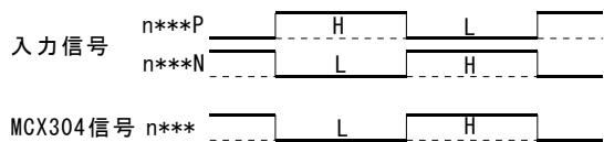
下図にエンコーダA/B相入力信号と差動出力のラインドライバとの接続例を示します。
