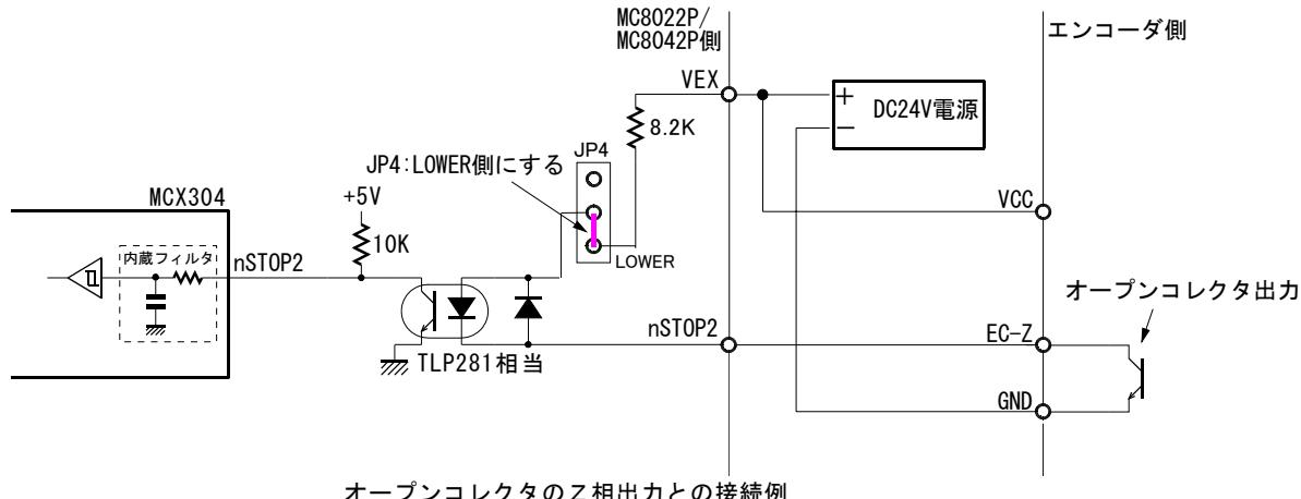
下図はnSTOP2入力信号とラインドライバ出力の片端子とエンコーダとの接続例です。出力がZ相検出時Lowレベルの場合は、MCX304の論理設定はWR1レジスタのD4(SP2-L)ビットを0(リセット時の状態)にセットします。
