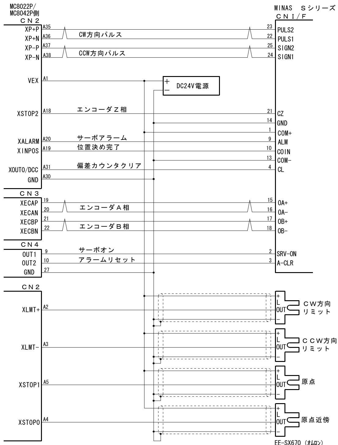
注1：ドライバの制御モード設定は位置制御モードに、指令パルス形態はCW/C CWパルスモードにパラメータセットします。
