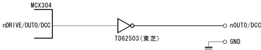
nOUT0/DCC出力は、汎用出力信号(nOUT0)信号と偏差カウンタクリア出力(DCC)との兼用端子で、CN2に出力されています。リセット時にはOFF状態になっています。本信号の制御は、他の汎用出力とは異なり、MCX304のレジスタ書き込みによって行います。
