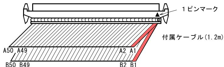
付属ケーブルは、上図に示すように、コネクタの1ピンマーク(三角印)を右上にしたとき、上側ケーブルの右(赤線)から左に向かってA1,A2,⋯ A49,A50、下側ケーブルの右(赤線)から左に向かってB1,B2,⋯ B49,B50となります。
