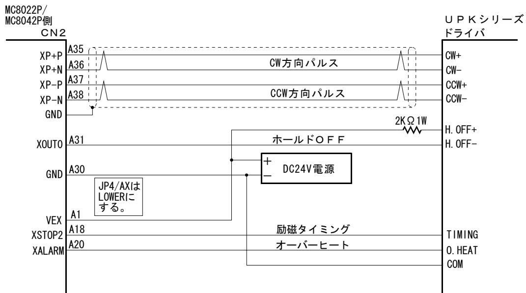
注1：ホールドOFF、効率タイミング、オーバーヒート信号は必要に応じて配線します。ホールドOFF信号は、MCX304のWR5レジスタのD0=1でXOUT0信号を有効にし、WR4レジスタのD0ビットに0,1を書き込むことによって制御します。原点励磁信号は、WR1レジスタのD4, 5ビットをモード設定して、原点検出動作を行わせることができます。オーバーヒート信号は、WR2レジスタのD12, 13ビットをモード設定してアラーム機能を働かせることができます。また、効率タイミング、オーバーヒート信号は、RR4レジスタを通して直接信号レベルを読み出すことができます。
