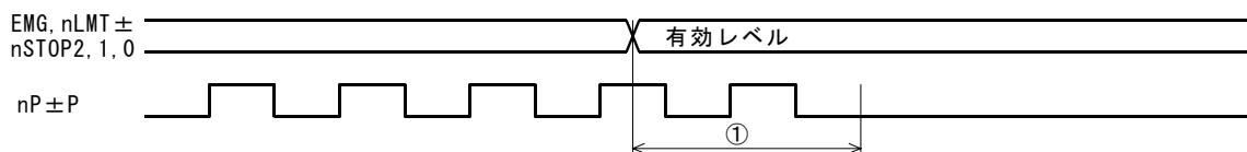
① ドライブ途中で外部停止信号が有効レベルになると、フォトカプラ遅延時間（最大100 μ sec）+ I C内蔵積分フィルタの遅延時間（初期値512 μ sec）+ 1 ドライブパルス後に停止します。
