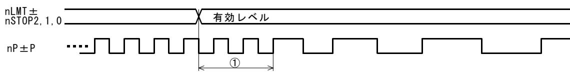
① ドライブ途中で外部減速停止信号が有効レベルになると、フォトカプラ遅延時間（最大100 μ sec）+ I C内蔵積分フィルタの遅延時間（初期値512 μ sec）+ 2 ドライブパルス後に減速を開始します。
