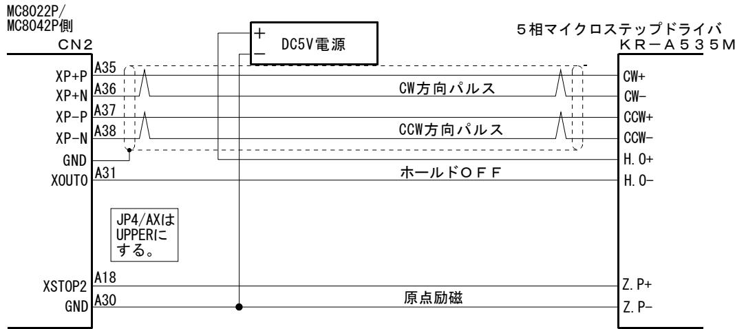
注1：ホールドOFF、原点励磁信号は必要に応じて配線します。ホールドOFF信号は、MCX304のWR5レジスタのD0=1でXOUT0信号を有効にし、WR4レジスタのD0ビットに0,1を書き込むことによって制御します。原点励磁信号は、WR1レジスタのD4, 5ビットをモード設定して、原点検出動作を行わせることができます。また、原点励磁信号は、RR4レジスタを通して直接信号レベルを読み出すことができます。
