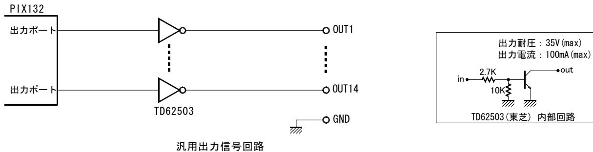
OUT1～14汎用出力信号は、C N 4より出力されます。信号のON/OFF制御は、PIX132（ノヴァ電子製）の各ポートに書き込むことにより行います。PCシステム起動時の各ポートは、出力OFFにセットされます。
