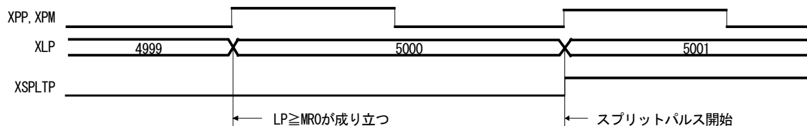
図 2.7-4 MRm 比較によるスプリットパルス出力タイミング
